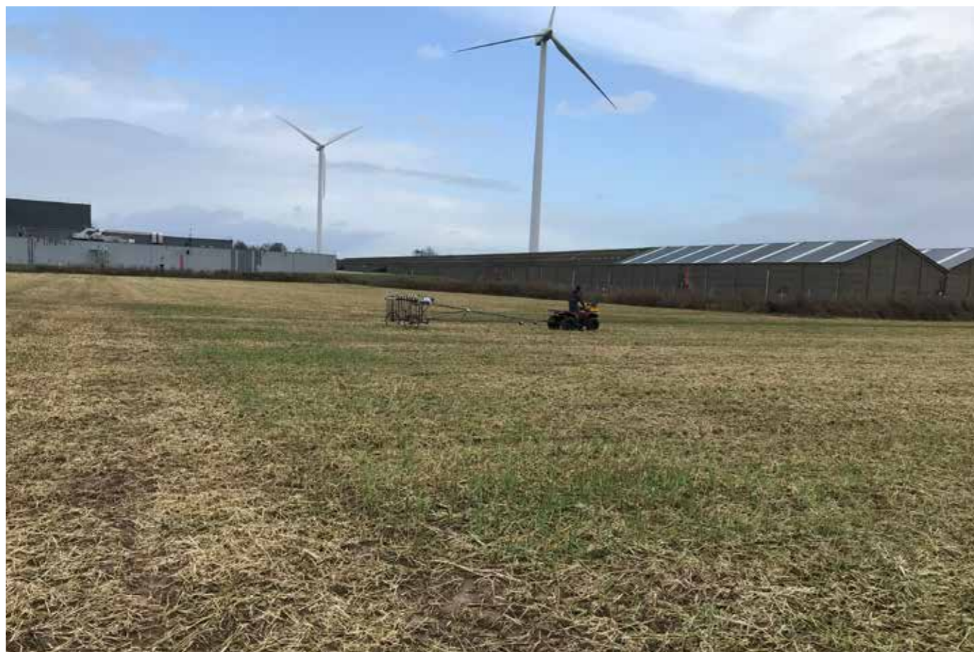
Geofysisch onderzoek met magnetometer (bron: 3Dsoil).
